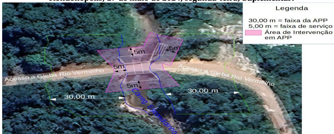
Figura 01- Imagem da descrição da obra e intervenção antrópica, em APP e ZUC- Zona de Unidade de Conservação para implantação de obra de drenagem e travessia na via de acesso a Gleba do Rio Vermelho, Rondonópolis-MT.
