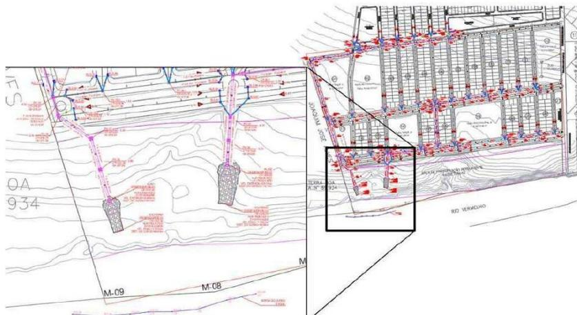
Figura 01 - Projeto de Drenagem pluvial apresentado no Anexo I, com foco no pronto de intervenção na APP para lançamento da rede 01 e da rede 02.
