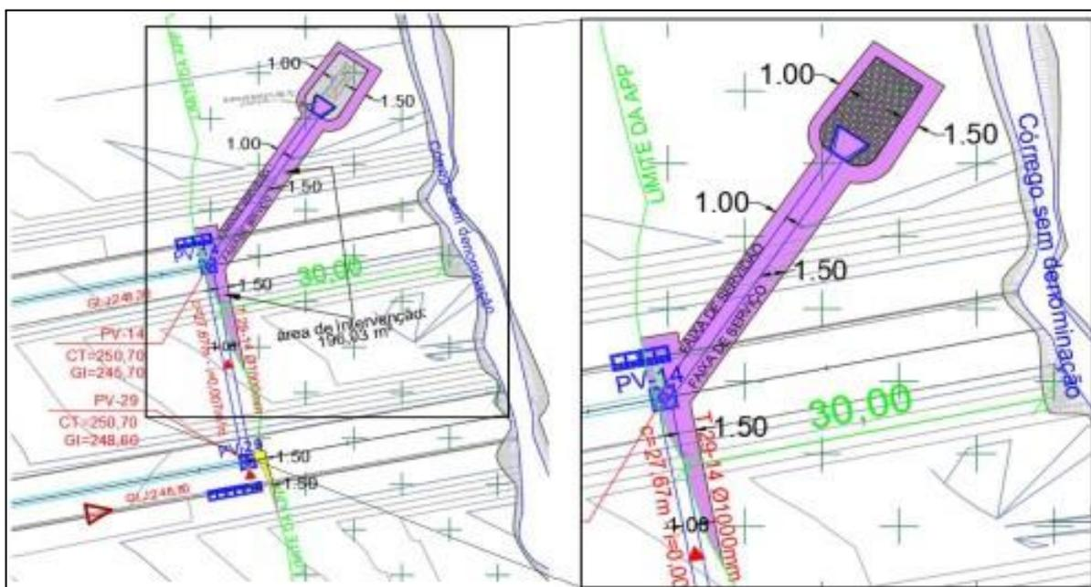
Figura 2- Print da Planta de intervenção apresentada no Anexo II, focando área da hachura rosa (supressão de vegetação para trecho final de rede e lançamento).
