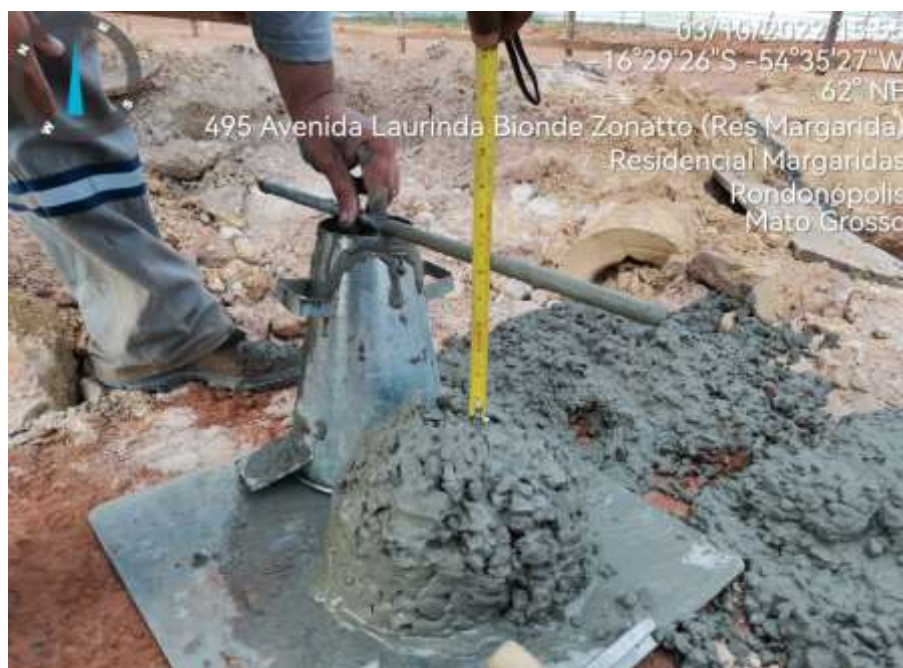
Imagem 03: Concreto retirado do caminhão com restos de sacos de cimento, cimento sem estar homogêneo.
