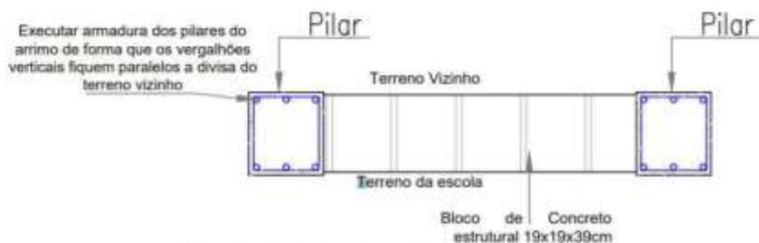
Figura 02 – Detalhamento dos pilares do muro de arrimo.
