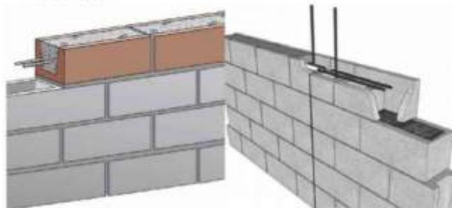
**5 Modelo Genérico das Armaduras do Muro de Arrimo**
