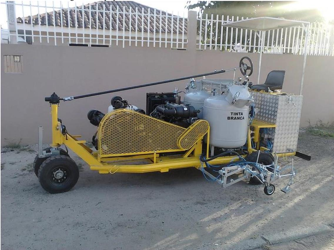
Analisando a imagem pode-se verificar, sem muita expertise, que o equipamento ofertado não possui assento para o operador com regulagem da posição horizontal, vertical, lateral, frente e trás, além disso não possui capô para o conjunto moto compressor, também foi verificado que o reservatório para tinta possui apenas quatro presilhas, duas a menos do exigido no Termo de Referência do Edital.
