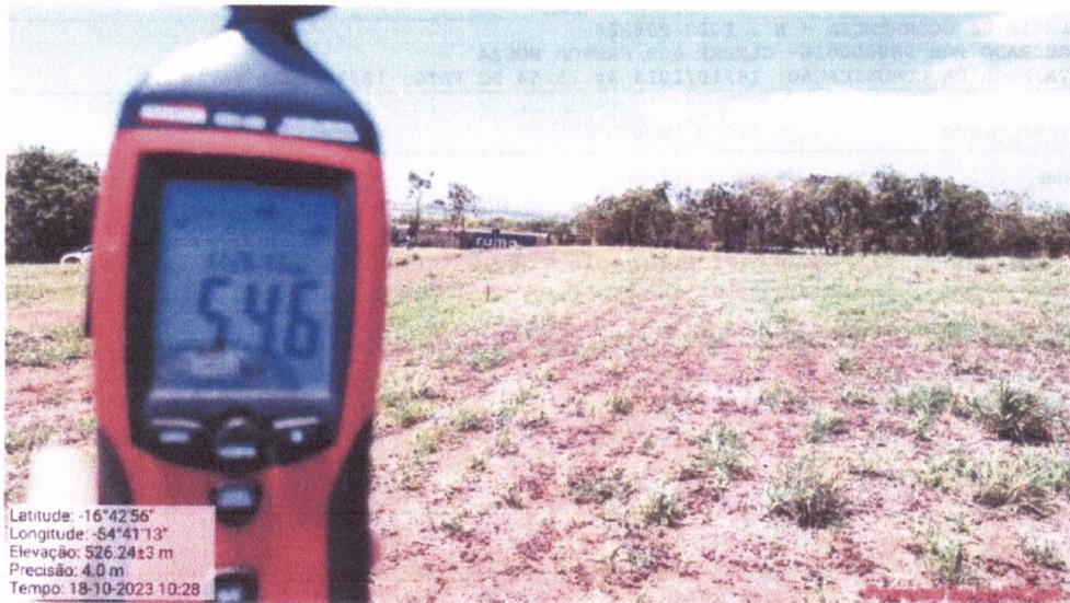
Imagem 07- Imagem da aferição do ruído da locomotiva em movimento a 100 metros da ferrovia
