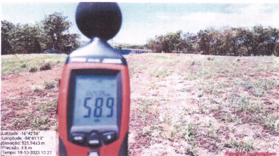
Imagem 04- Imagem da aferição do ruído da locomotiva em movimento a 80 metros da ferrovia.
