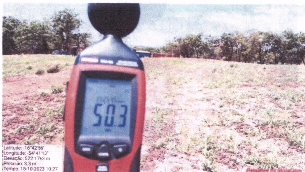
Imagem 05- Imagem da aferição do ruído da locomotiva em movimento a 80 metros da ferrovia.
