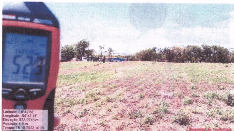
Imagem 06- Imagem da aferição do ruído da locomotiva em movimento a 100 metros da ferrovia.
