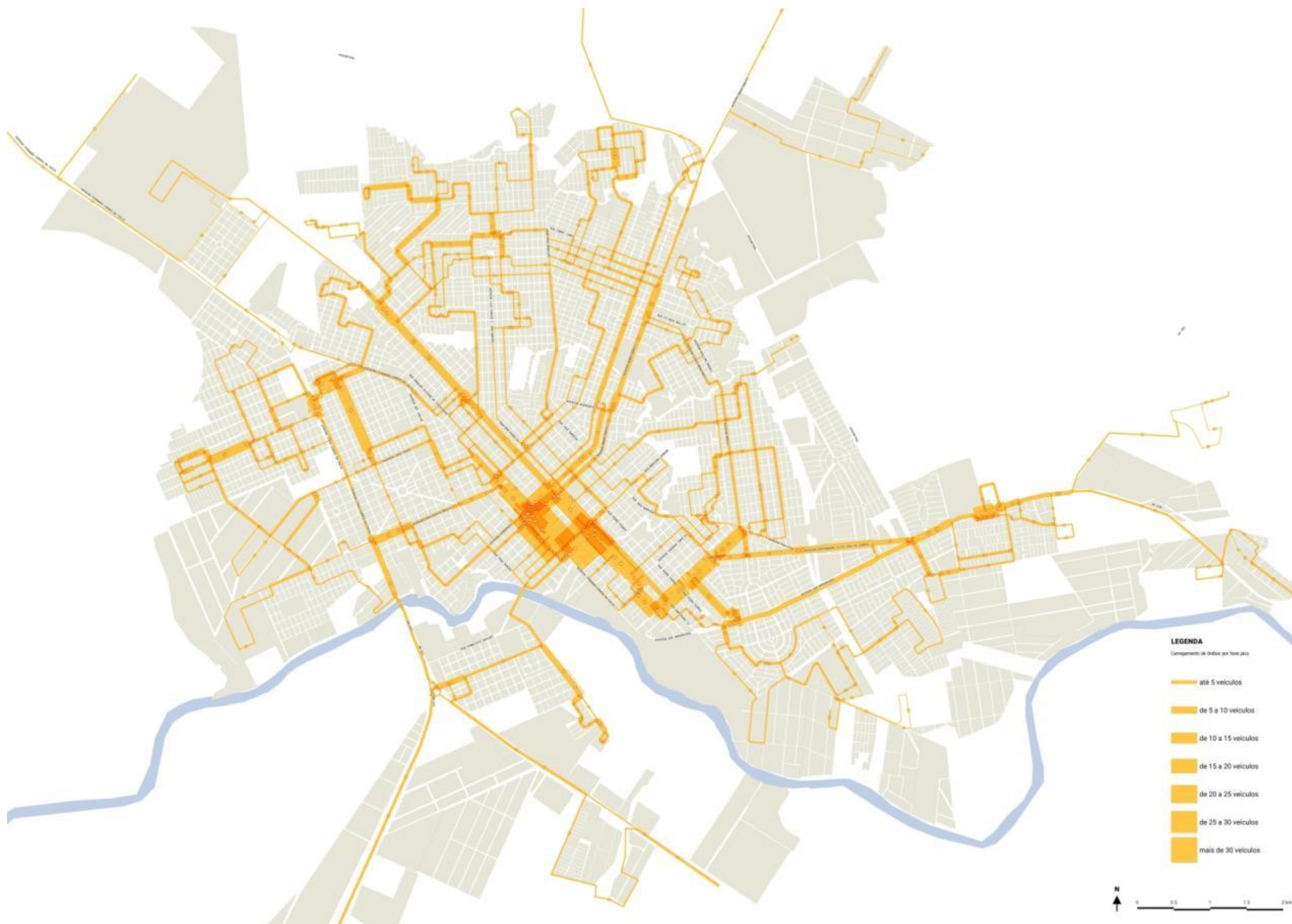
Figura 133: Carregamento das Linhas de Transporte Coletivo
