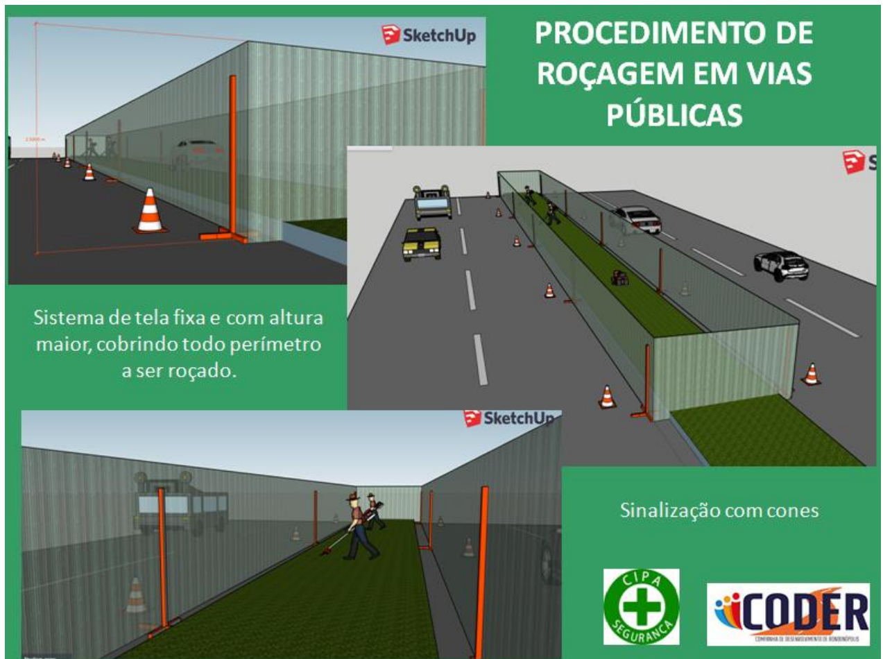
Uso de proteção contra a projeção de materiais e sinalização de segurança.
