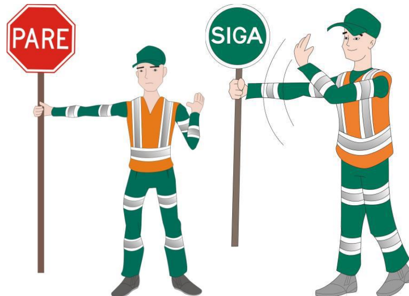
Figura 31: Trabalhador controlando os veículos em operação PARE/SIGA.
