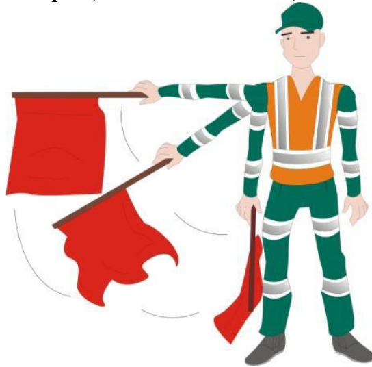
Figura 30: Trabalhador utilizando bandeira para controle de trânsito.
